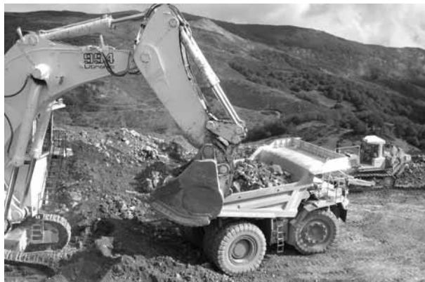
Photo 4. Chargement d'un Komatsu de 100 t à la pelle Liebherr 994 (cliché Gérard Sustrac).
