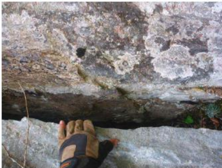
Mesure d'ouverture d'une fracture
