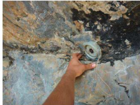
Mesure d'inclinaison d'une faille
